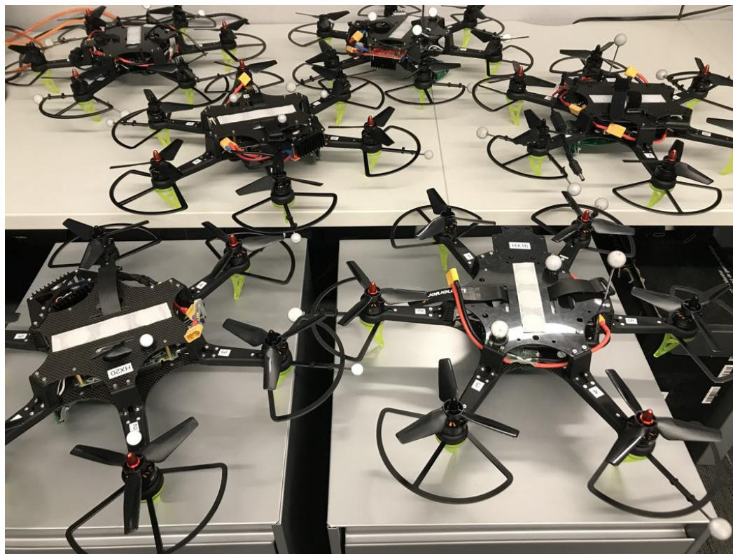
自作したドローンたち。NUCを積んでいるのでかなり大きくなってしまった
